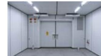
Deux en un (solution hybride) : salle d'essais climatiques et acoustiques, Denso, Eching, Allemagne
