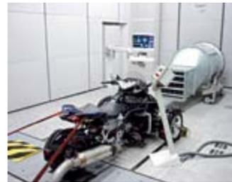
Salle de mesures acoustiques d'un véhicule complet ; BRP-Rotax, Autriche
