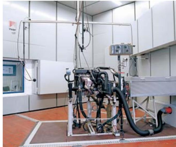
Salle de mesures acoustiques de composants dans l'automobile: banc d'essais vibro-acoustiques moteur, VEMS, Aachen
