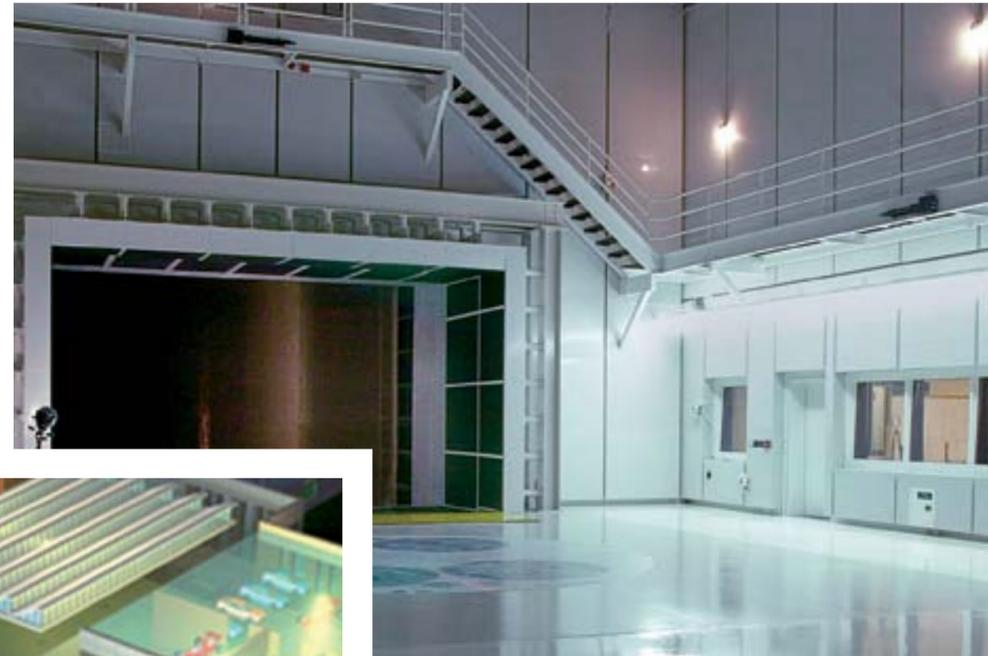
Revêtement acoustique du plénum d'expérimentation et du diffuseur; (DaimlerChrysler, Auburn Hills, EUA)
