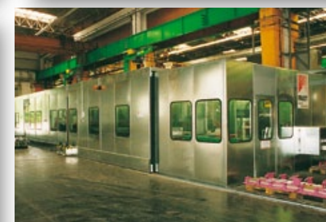
Encoffrement mobile d'un centre d'usinage ; Affaiblissement acoustique 25 dB ; Siemens, AT-Vienne
