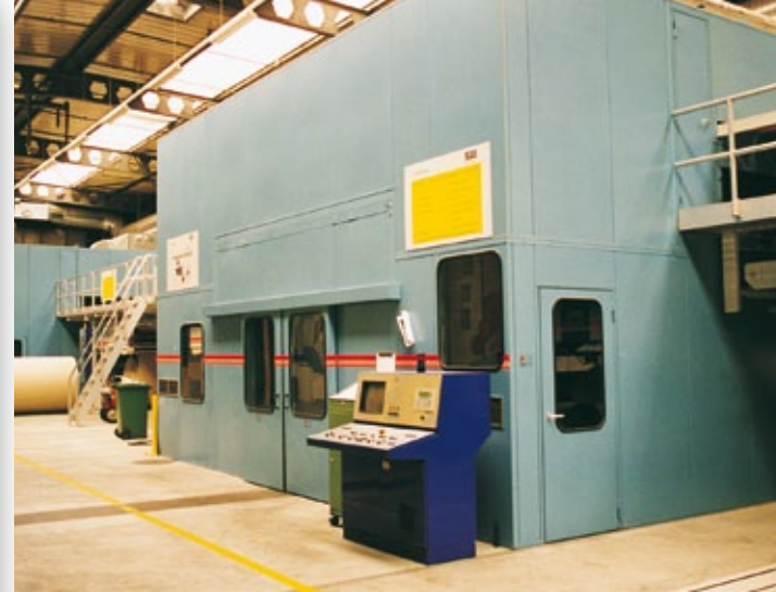
Capot insonorisant d'une onduleuse (production de carton) ; Affaiblissement acoustique 25 dB Model AG, CH-Weinfelden
