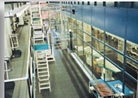
Salle de commande insonorisée d'une rotative d'imprimerie de journaux. Affaiblissement acoustique 28 dB ; MVD, D-Potsdam
