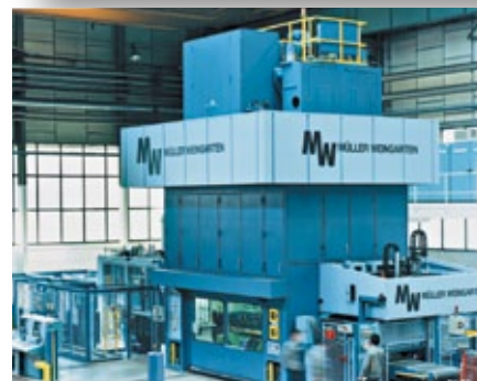
Encoffrement d'une presse. Affaiblissement acoustique 22 dB ; Renault, F-Le Mans
