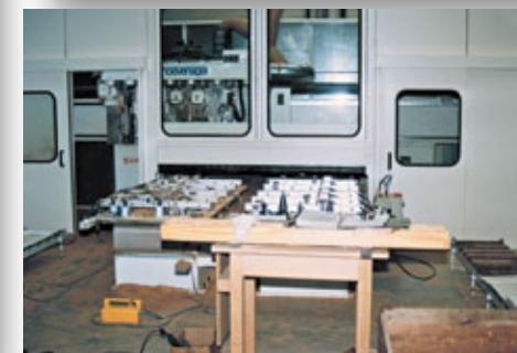
Fraiseuse CNC dans l'industrie du bois avec encoffrement ; Affaiblissement acoustique 26 dB
