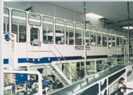
Salle de commande insonorisée d'une rotative d'imprimerie de labeur. Affaiblissement acoustique 28 dB ; Strohal Druck, AT Müllendorf
