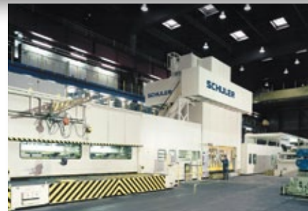
Encoffrement d'une presse de transfert et entrée de bande. BMW, D-Dingolfing
