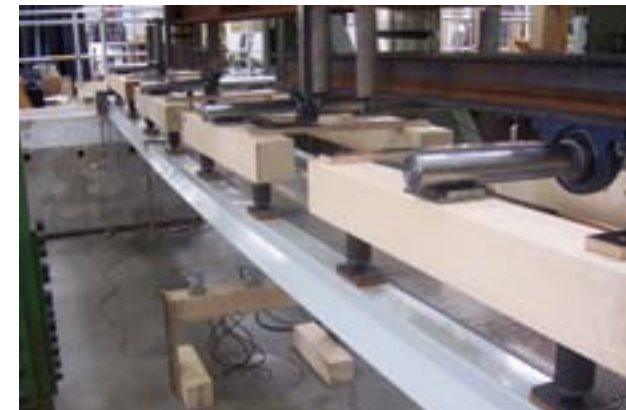
Ci-dessus : banc d'essai de comportement mécanique (panneau FAIST type Rail A2 en position horizontale en bas de la photo)
