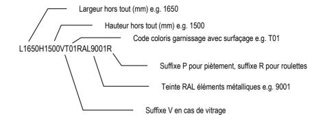
Dans cet exemple: largeur hors tout 1650 mm, hauteur hors tout 1500 mm, avec vitrage, code coloris garnissage avec surfaçage T01 (blanc cassé), teinte éléments métalliques RAL9001 (blanc), avec roulettes
