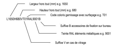
Dans cet exemple : largeur hors tout 1650 mm, hauteur hors tout 680 mm, avec vitrage, code coloris garnissage avec surfaçage T01 (blanc cassé), teinte éléments métalliques RAL9001 (blanc), avec accessoires de fixation pour bureau
