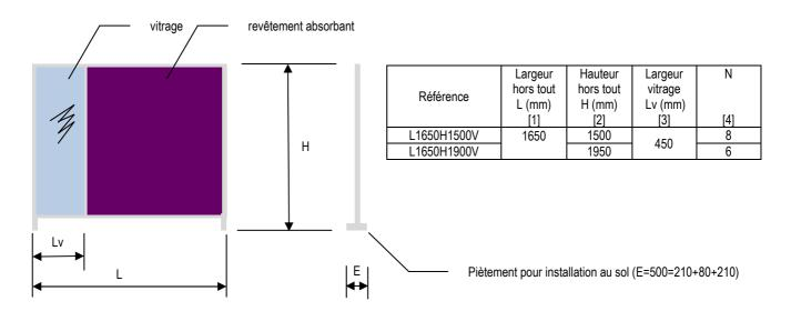
Exemple de désignation des claustras à haute absorption acoustique ITS pour installation au sol
