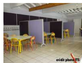
revêtement absorbant mural et écrans acoustiques pour réduction de la réverbération d'un restaurant scolaire
