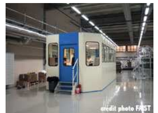
poste de commande insonorisé (industrie du carton)
