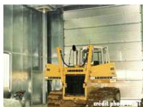
banc d'essais insonorisé (industrie mécanique)
