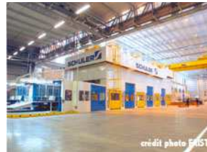
encoffrement d'une ligne de presses (industrie automobile)
