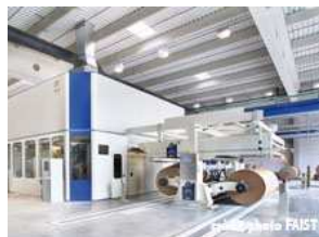
encoffrement d'une onduleuse (industrie du carton)
