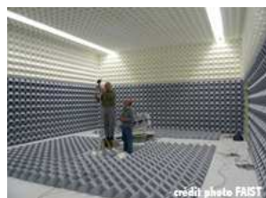
revêtement absorbant à base de dièdres pour une salle anéchoïque (industrie électronique)
