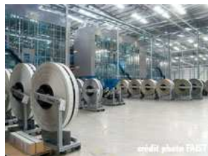
cloisonnement insonorisant d'une rotative (imprimerie)
