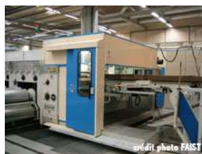
cartérisation d'une machine d'impression (industrie du carton)
