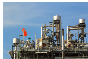
silencieux de décharge / détente (dépressurisation de fluides)
