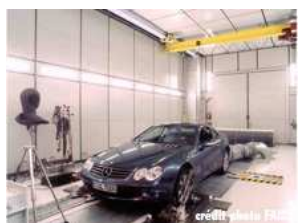
revêtement absorbant à base d'absorbants compacts pour une salle anéchoïque (industrie automobile)
