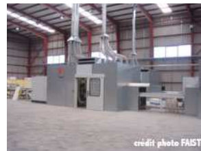
encoffrement d'une raboteuse (industrie du bois)
