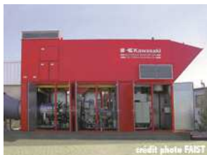
système d'admission d'air d'une turbine à gaz (intégré à un encoffrement: package d'insonorisation)
